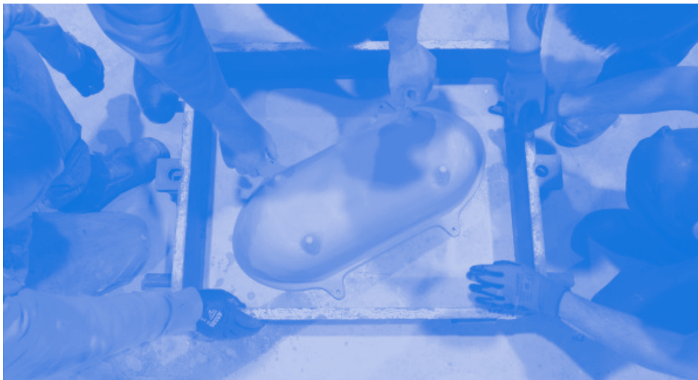
Image du projet à la fonderie de St Dizier. Pièce du barbecue en train d'être démoulé.
