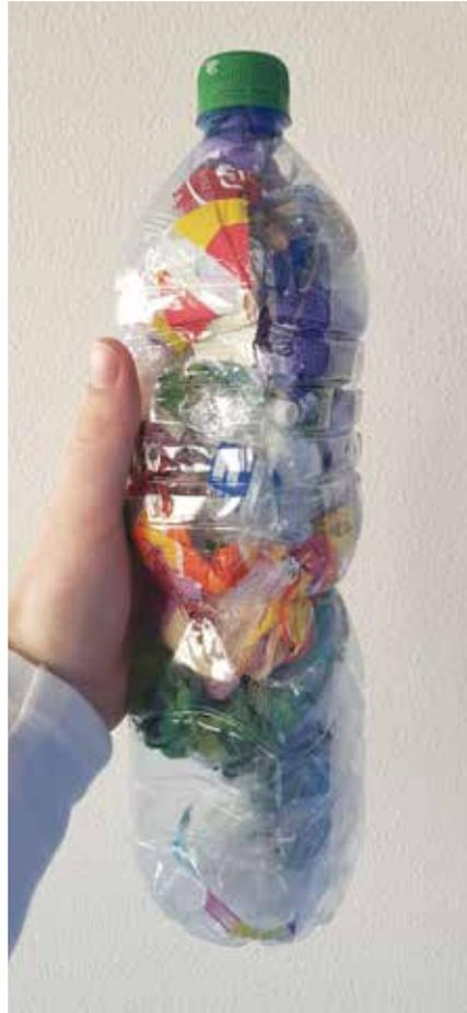
Fig. 15 Réalisation d'une éco-brique
