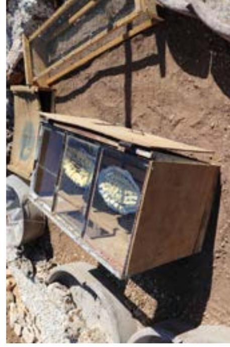
(Fig48) Prototype de séchoir solaire, Guenat Emeline, InsituLab 2020
