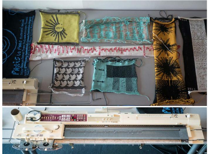
Le tricodeur, la machine à tricot automatique, ainsi que les motifs générés par processing et par la machine.
