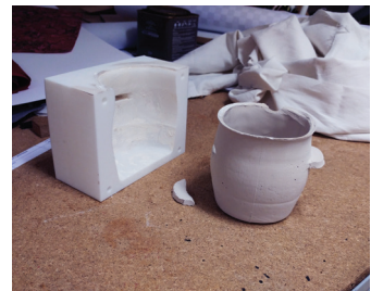
Test de moule en céramique imprimé en 3D, au résultats pour le moment mitigés.
