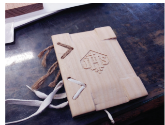
La découpe à la commande numérique permet d'obtenir des décors précis sur les couvertures en bois.
