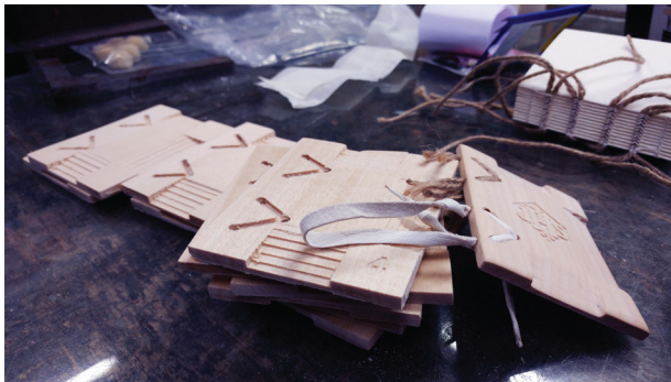
Couverture en bois de reliure médiévale (ais), que nous avons découpées à la fraiseuse numérique, pour Maurice Salmon.
