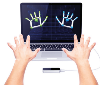
Le Leap Motion, système de captation du mouvement des mains pour la réalité virtuelle.
