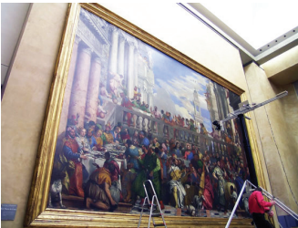
Scanner 3D du tableau Noces de Cana de Véronèse par Factum Arte, en vue de faire un fac-similé.
