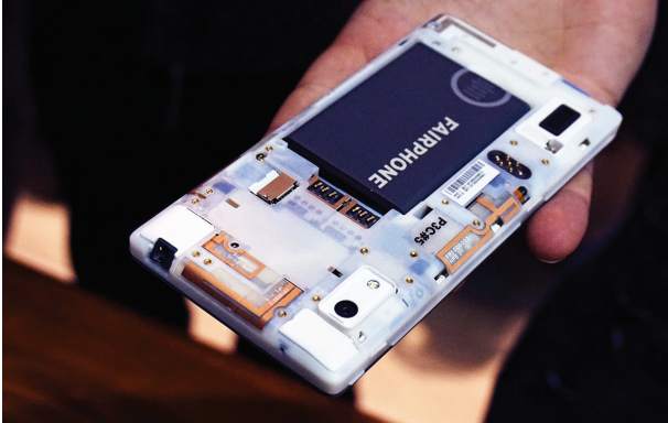
Le Fairphone, un téléphone conçu pour être plus durable que ces concurrents, fonctionnant avec des pièces détachées accessibles et remplaçables, et encourageant le recyclage. Entreprise Fairphone fondée par Bas van Abel
