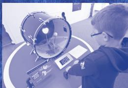
Le but de ce dispositif est de poser les mains sur un capteur qui va analyser les battements cardiaques. Un tambour connecté au capteur retranscrit quelques secondes plus tard le rythme cardiaque exact de la personne.
